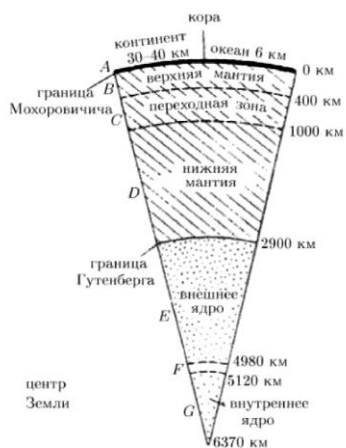
Рис. 2.4. Семь концентрических зон внутри Земли (схема Буллена)
