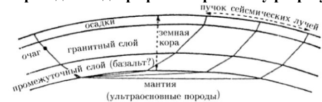
Рис. 2.6. Ход сейсмического луча от ближайшего землетрясения в слоистой земной коре
